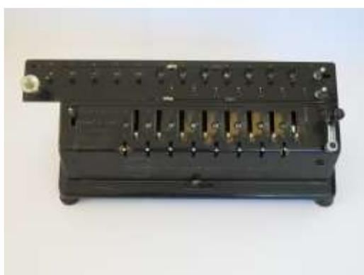
clone de l'arithmomètre (cylindres cannelés de Leibniz)
